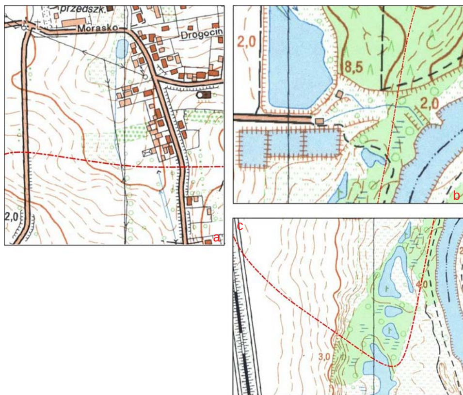
Ryc. 2. Przykładowe błędy popełnione przy wyznaczaniu „starej” granicy zlewni Różanego Strumienia: a) granica zlewni przecina ciek, b) granica zlewni nie obejmuje ujścia Różanego Strumienia do Warty, c) granica zlewni przecina zbiornik wodny
