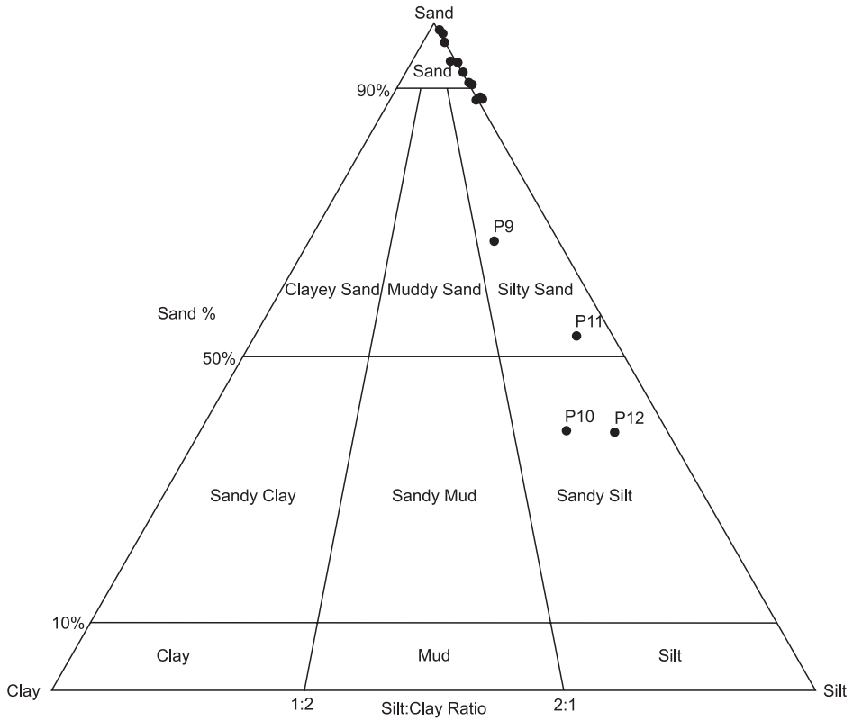
Ryc. 3. Diagram trójkątny przedstawiający procentową zawartość różnych typów osadu
