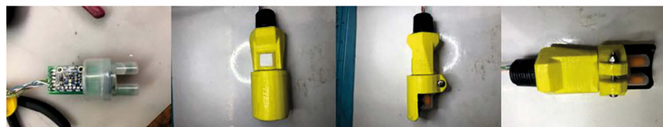
Ryc. 4. Urządzenie do pomiaru mętności zaproponowane przez Trevathana. A – schemat układu pomiarowego, B – sonda pomiarowa z czujnikiem mętności (Trevathan i in., 2020)
