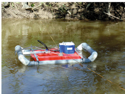
Ryc. 5. Akustyczna metoda pomiaru. A – urządzenie ADCP (StreamPro firmy Teledyne RD Instruments), B – schemat pomiaru urządzeniem ADCP z powierzchni wody w kierunku dna
